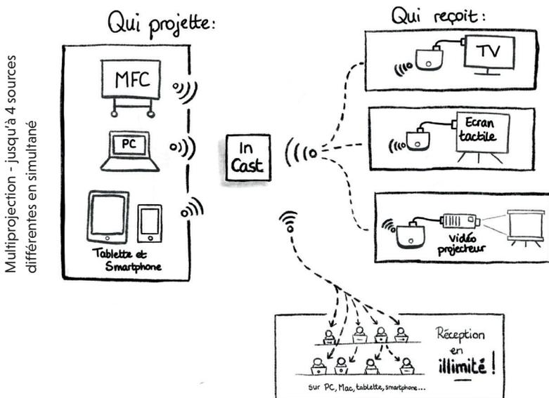
Multiprojection - jusqu'à 4 sources différentes en simultané
